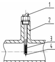
图 19 直面管道的插入方式
