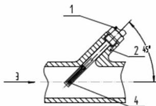
图 20 斜面管道的插入方式
