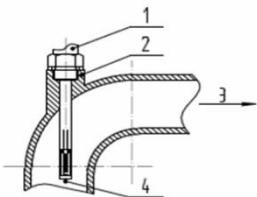
图 18 弯头管道的插入方式
